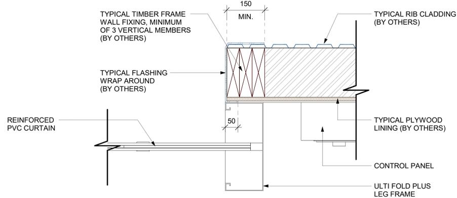
**1 TYPICAL WALL FIXING DETAIL**
